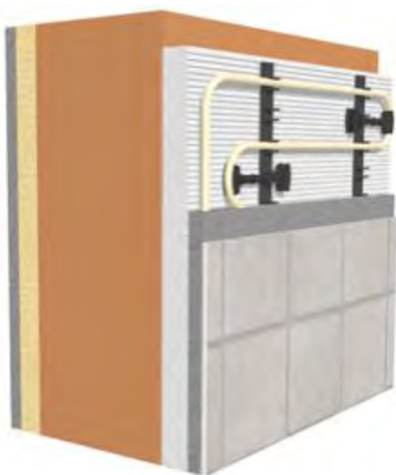
fig.2.3 Sistema ECOwall FIT con rivestimento in ceramica
