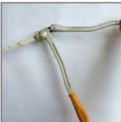
5-tornare alla posizione iniziale girando leggermente lo strumento nel tubo
