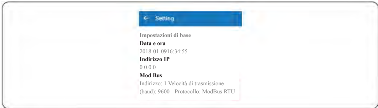
Figura 5.21 Verifica dell'indirizzo Modbus
